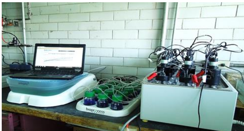
Figura 4.8. Equipo AMPTS II para determinación de potencial bioquímico de metano
