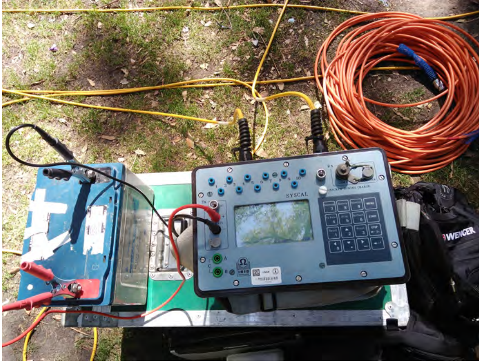
Figura 4.2: Equipo utilizado para la adquisición de datos. Lado derecho, batería de 12 V, lado izquierdo Syscal Pro Standard & Switch® de 48 canales.
