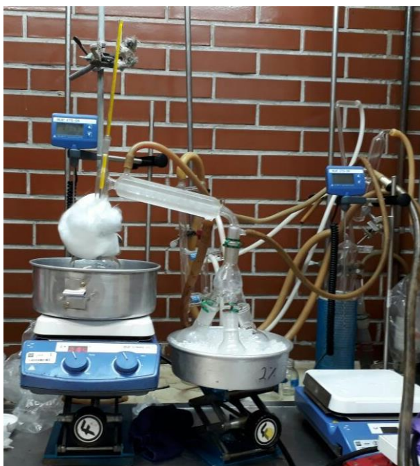
Figura 10. Equipo montado para el proceso de eliminación del inhibidor.
