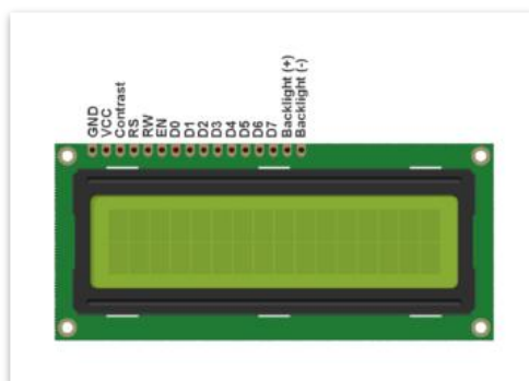
Fig. 150. Pines de conexión Display LCD 16x2.
