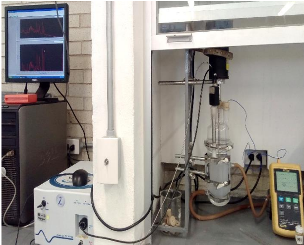
Figura 3.2 Montaje de las polimerizaciones en un baño agitado de temperatura controlada y un reactor por lotes.
