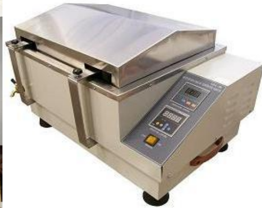
Figura 3.2 Montaje de las polimerizaciones en un baño agitado de temperatura controlada y un reactor por lotes.
