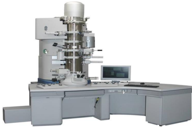
Figura 3.4 Microscopio electrónico de transmisión JEOL JEM-2010.
