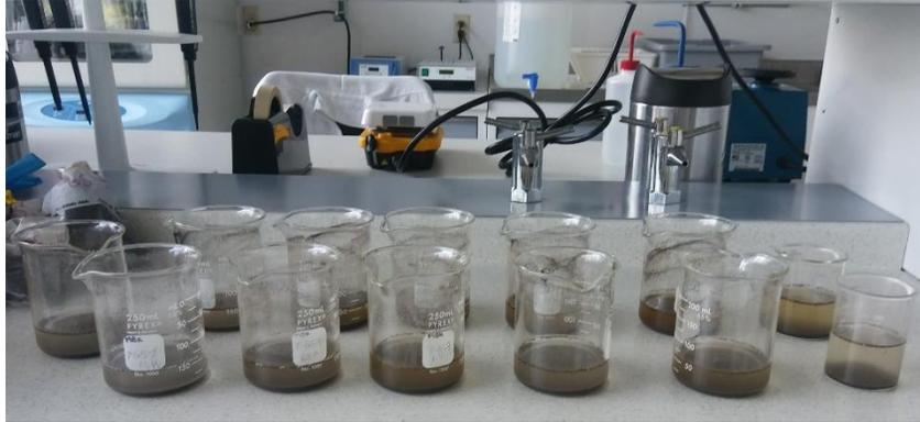
Figura 4. Vasos de precipitado con 50 mL NaOH 1% con muestra de suelo.
