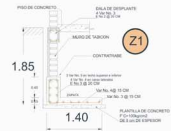
Detalles de Zapatas
