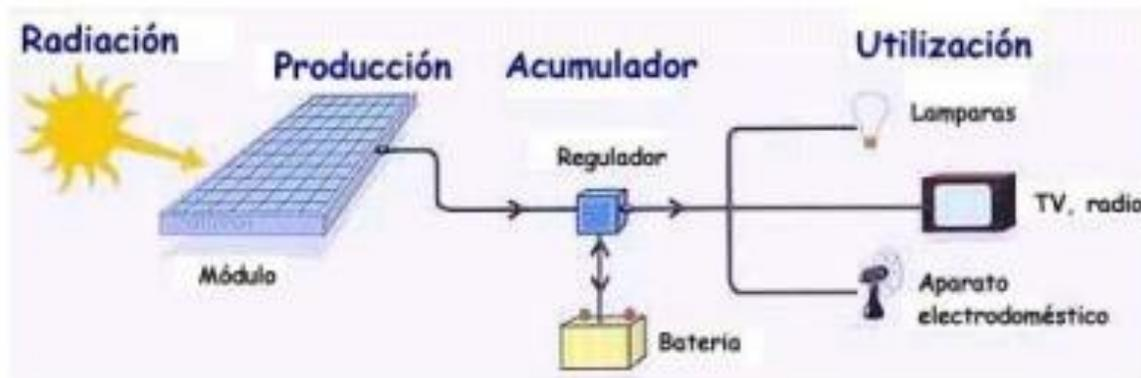
Figura 30. Funcionamiento e implementación de células fotovoltaicas.
