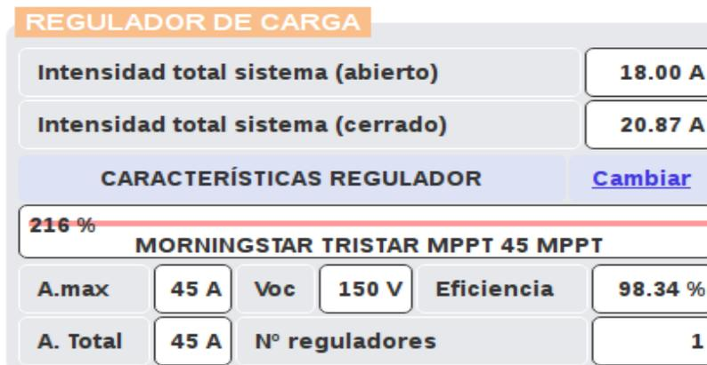
Figura 54. Especificación técnica del regulador de carga.
