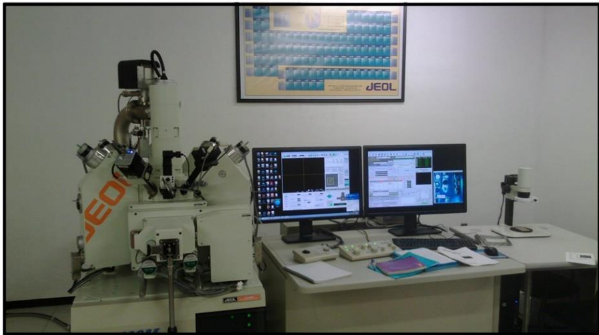
Fig. 4.29. Microsonda electrónica (EPMA) utilizada para el análisis de óxidos mayores en inclusiones de fundido.
