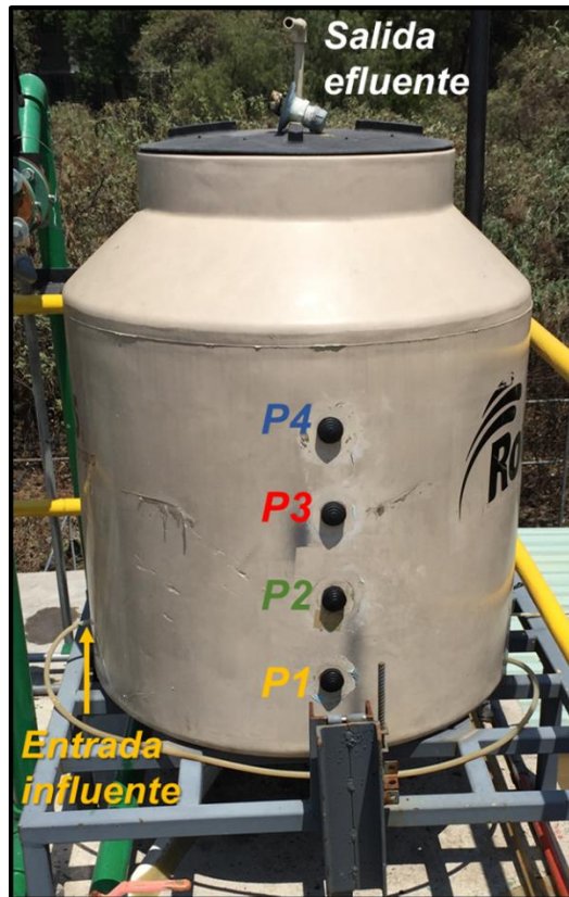
Figura 4.12. Fotografía de biofiltro e identificación de los puntos de muestreo y salida y entrada de gases.
