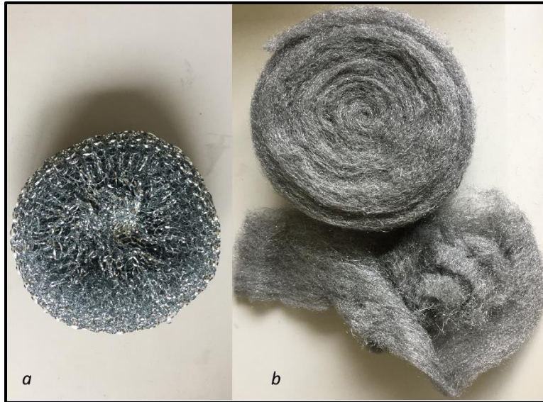
Figura 4.11. Materiales de empaque utilizados para tratamiento de H_2S : a) fibra de metal, b) lana de acero.
