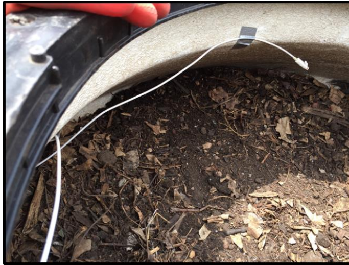
Figura 4.13. Fotografía de medio filtrante (composta) dentro de biofiltro.
