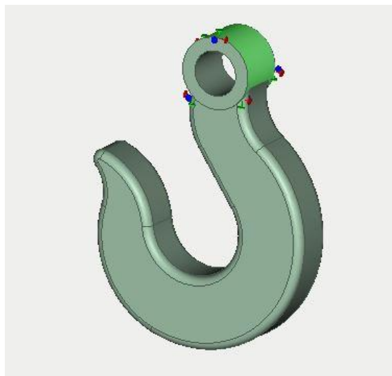
Figura 3.61 Definición de las restricciones de la pieza “gancho”, en AutoFEM®
