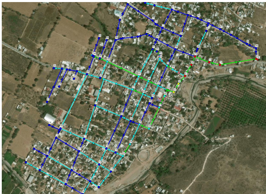
Figura 46. Red de drenaje pluvial diseñada con hidrogramas de IBER.
