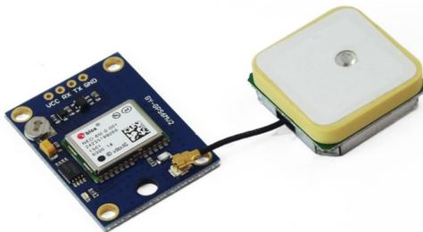
Imagen 12. Módulo GPS GY-GPS6MV2.<sup>19</sup>
