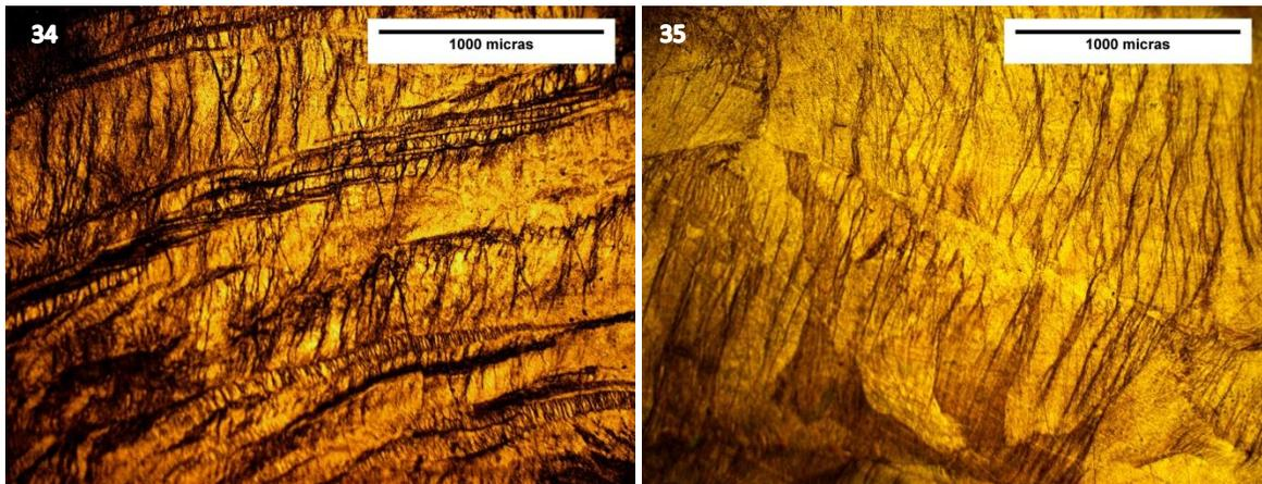
Figuras 34 y 35. Microestructuras de Latón laminadas y precalentadas a (34) 350°C y (35) 450°C
