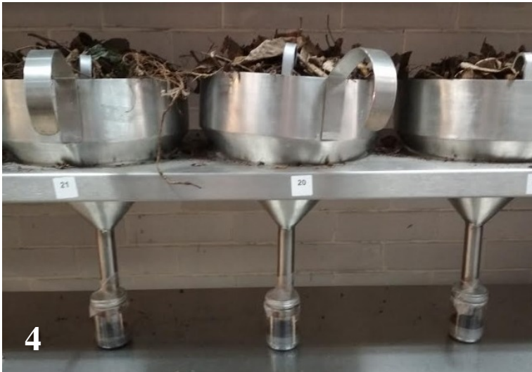
Figuras 4-5. Materiales para la obtención y mantenimiento de los ejemplares de Pergalumna sp. nov. 4. Procesamiento de muestras de hojarasca y suelo en Embudos de Berlese-Tullgren con frascos de cultivo. 5. Medios de cultivo usados para la crianza.
