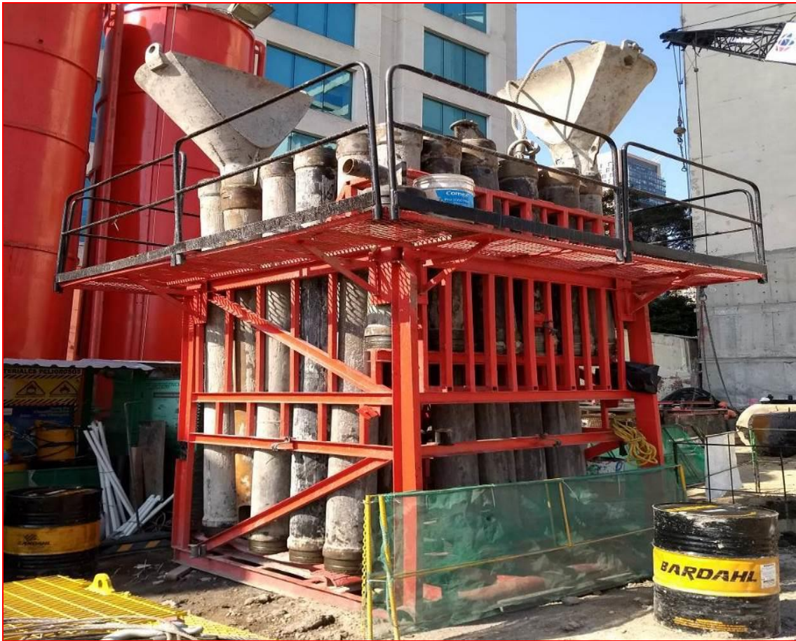
Figura 60. Almacén (Rack) de tubería Tremie, incluye las tolvas para vaciado de concreto; proyecto "MARHNOS, Lago Filt 7". (CIMESA 2018).
