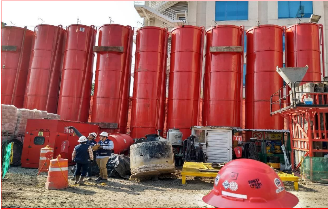
Figura 66. Planta de lodos típica, con silos de 40 y 45 m 3 de capacidad máxima; proyecto "MARHNOS, Lago Filt 7". (CIMESA 2018).
