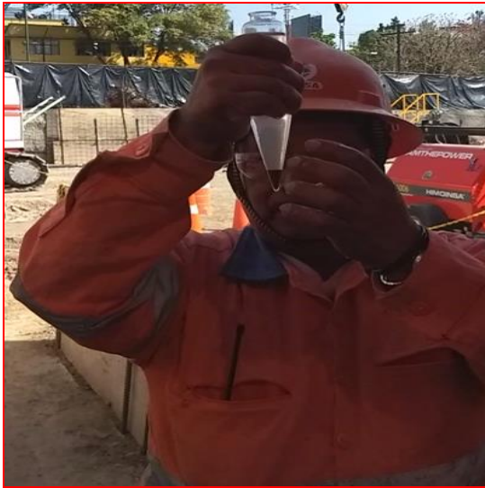
Figura 83 y 84. Verificación de la prueba de contenido de arena; proyecto "MARNHOS, Lago Filt 7". (CIMESA 2018).
