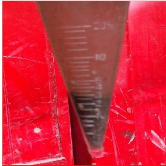
Figura 83 y 84. Verificación de la prueba de contenido de arena; proyecto "MARNHOS, Lago Filt 7". (CIMESA 2018).
