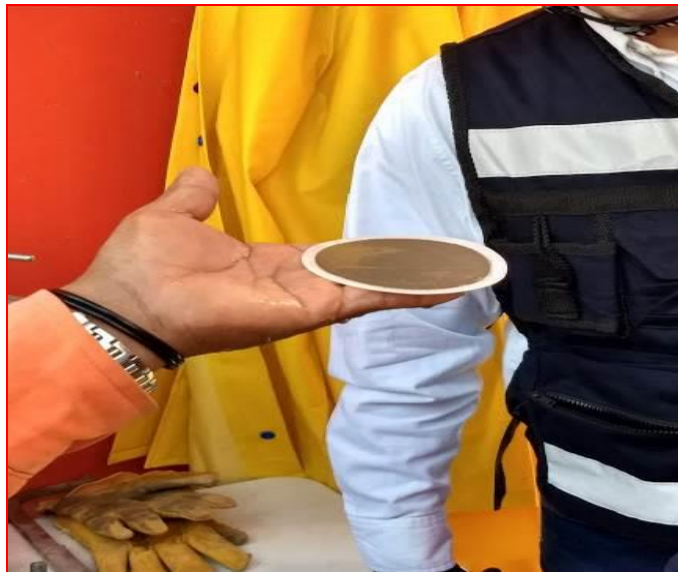
Figura 88. Verificación de los resultados de la prueba de cake; proyecto "MARNHOS, Lago Filt 7". (CIMESA 2018).
