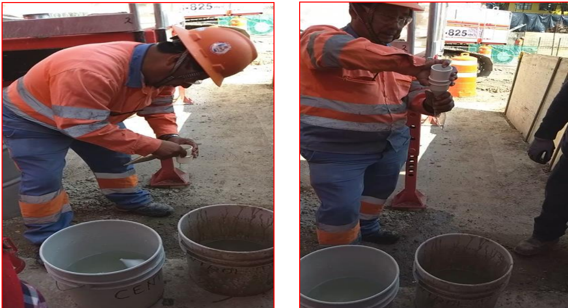
Figura 81 y 82. Realización de la prueba de contenido de arena; proyecto "MARNHOS, Lago Filt 7". (CIMESA 2018).
