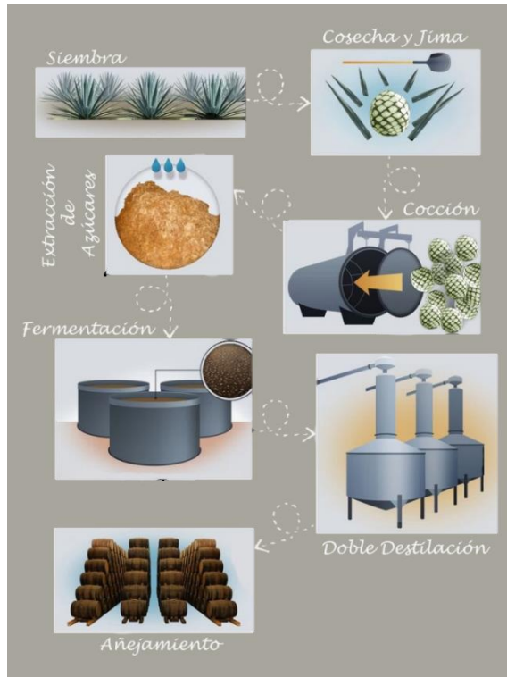
Figura 2. Diagrama de flujo para la elaboración del Tequila. (Imagen propia)
