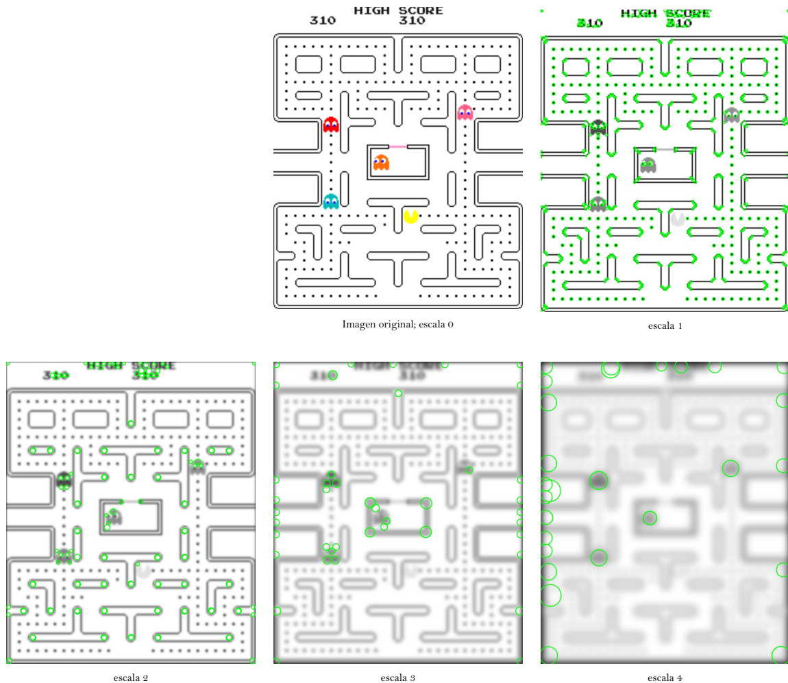
Figura 2.4: Ejemplo de la descomposición multi-escala de una imagen. El cuadro superior izquierdo corresponde a la imagen a escala original. El cuadro a la derecha de éste, corresponde a la imagen escalada por el factor más pequeño de los cuatro considerados. El cuadro inferior izquierdo representa la imagen escalada a un factor mayor que el anterior y así sucesivamente. Cada escala corresponde al inicio de una octava de acuerdo al método de SIFT [Lowe, 2004]. Finalmente, para cada una de las cuatro imágenes escaladas se han delimitado en color verde los puntos característicos detectados con dicho método.
