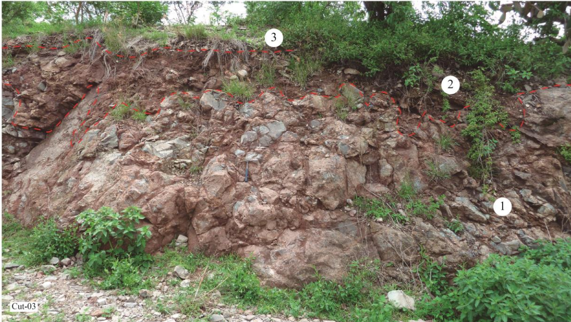
Fig. 20 Estación geológica Cut-03. Unidad 1: Material brechoso masivo constituido por bloques angulosos a subangulosos de color grisáceo. Unidad 2: Depósito aluvial con una matriz de color cafe oscuro y fragmentos subredondeados a subangulosos. Unidad 3: Capa de suelo de color oscuro (por humedad) con presencia de fragmentos de roca.
