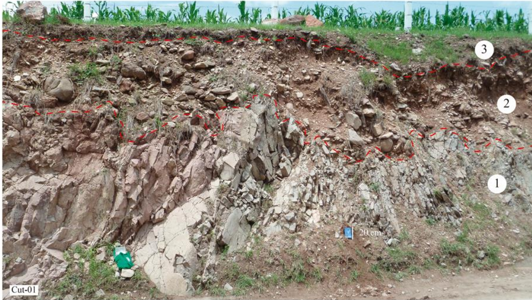
Fig. 19 Estación geológica Cut-01. Unidad 1: Basalto masivo y fracturado con coloración gris al fresco y tonos verde a la intemperie. Unidad 2: Depósito aluvial conformado por material matriz-soportados presenta un color café. Unidad 3: Capa de suelo de color café oscuro.
