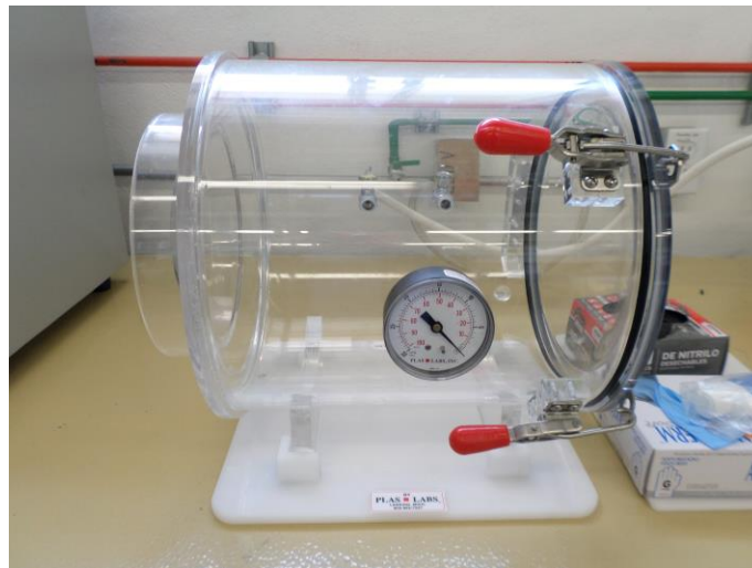
Fig. 13 Cámara de vacío Plas Labs (800-VAC/S)
