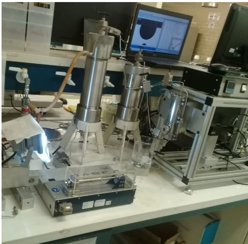
Figura 4.4: Goniómetro para el ángulo de contacto entre placa y gota de aceite (imagen proporcionada por la USIP)
