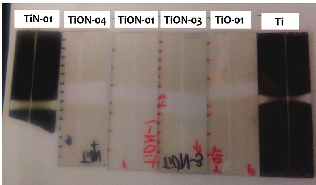
Figura 4.4: Depósitos preliminares realizados sobre vidrio.
