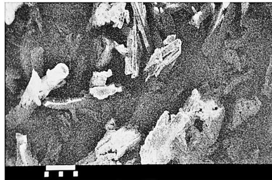
Figura 39. Micrografía de la muestra LQM 919 No 50 a 100x. El valor de la barra es 1000  $\mu\text{m}$ .
