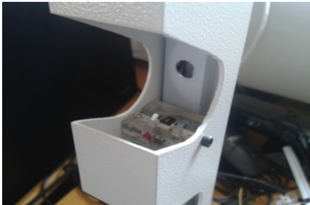
Figura D.23: Colocación del sensor de proximidad en los peldaños de la escalera
