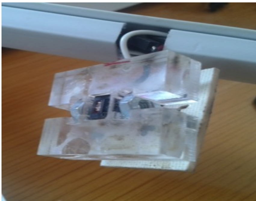
Figura D.22: Detalle del sensor de proximidad y circuito integrado
