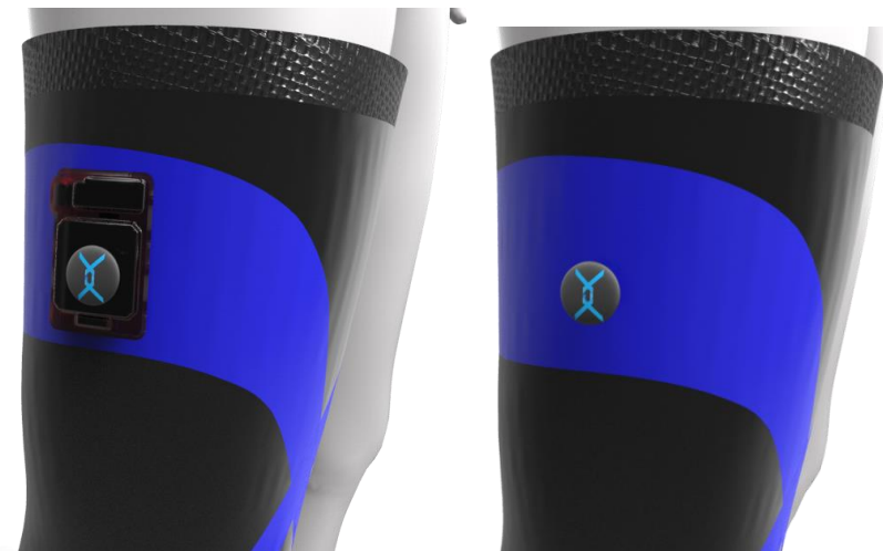
139.- Ubicación y proporción del circuito incorporado a la órtesis y en la imagen siguiente se muestra como queda oculta por dentro.
