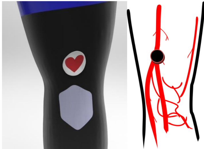
126.- Ubicación del sensor de pulso en la arteria poplítea que es una prolongación de la arteria femoral.
