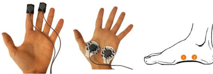
Imagen 2.2. Formas para colocar el sensor de conductancia de la piel. Dedos indice y medio, palma de la mano y pie (Tobii AB, 2018).
