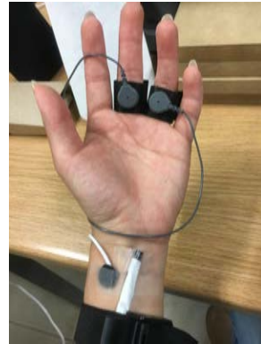
Imagen 5.1. Colocación de los sensores GSR, PPG (arteria radial) y ST.
