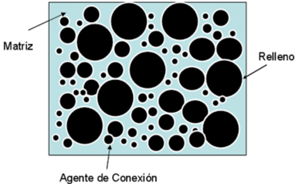
Figura 2. Componentes fundamentales de las resinas compuestas. Esquema general donde puede verse la matriz de resina, las partículas de relleno y el agente de conexión. ( https://www.actaodontologica.com/ediciones/2008/3/evolucion_tendencias_resinas_compuestas.asp , 2008)
