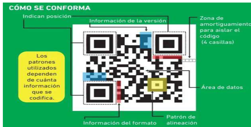
FIGURA 10.- ESTRUCTURA DEL CÓDIGO QR.
