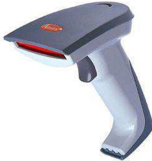
FIGURA 2.-DETECTOR DE CÓDIGOS DE BARRAS.
