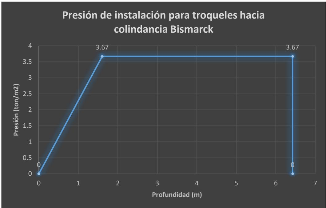
ILUSTRACIÓN. 22.- DIAGRAMA DE PRESIONES TRANSFORMADA DE PECK
