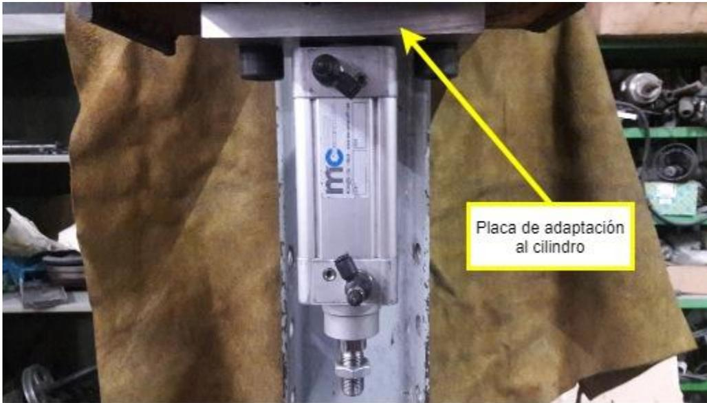
*Figura 61 Sujeción del cilindro al marco.*
