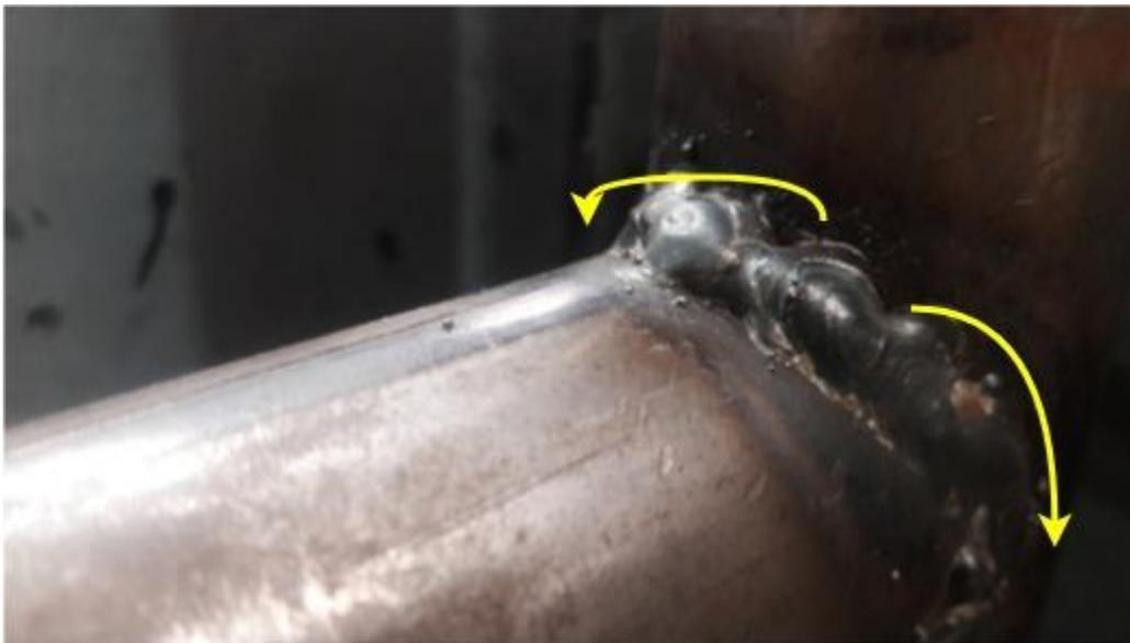
*Figura 69 Direcciones de propagación de la fractura.*
