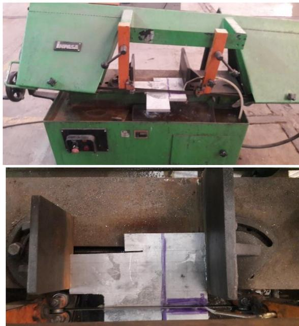
*Figura 55 Corte mediante sierra cinta de la adaptación del cilindro.*
