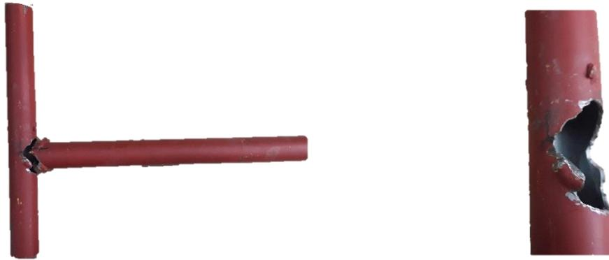
*Figura 105 Fractura de probeta soldada con MIG.*
