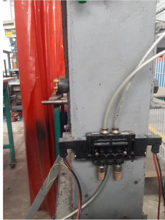
Figura 64 Montaje de la electroválvula 5/2.
