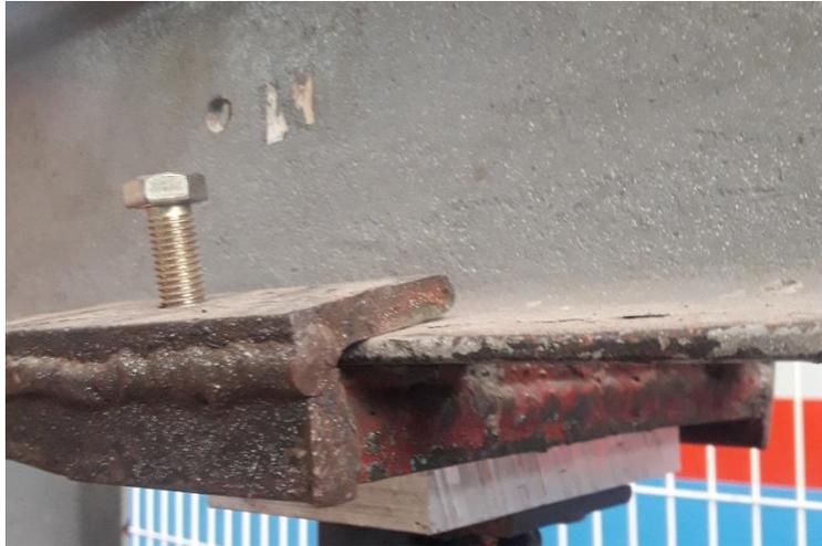
*Figura 75 Inmovilización de la placa móvil.*
