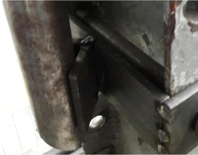
*Figura 88 Posicionamiento del perfil en "L" para crear la "V" del concepto.*
