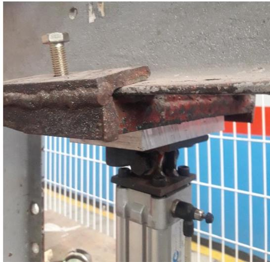
*Figura 94 Montaje del cilindro y su articulación en el banco.*
