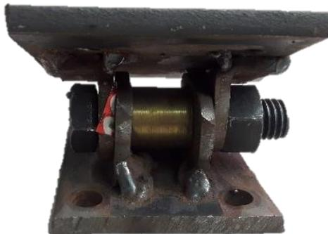
*Figura 93 Adaptación para la rotación del cilindro.*
