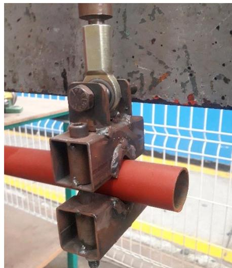
*Figura 100 Unión entre la extensión del vástago y la probeta.*
