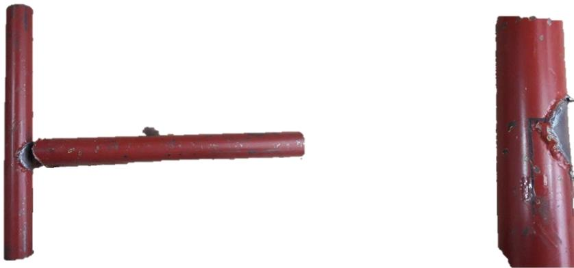
*Figura 104 Fractura de una probeta soldada mediante TIG.*
