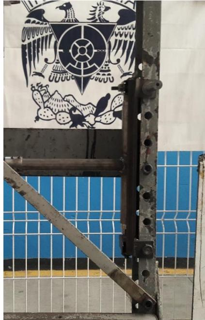
*Figura 63 Montaje del sistema de fijación por conos opresores, en el marco.*
