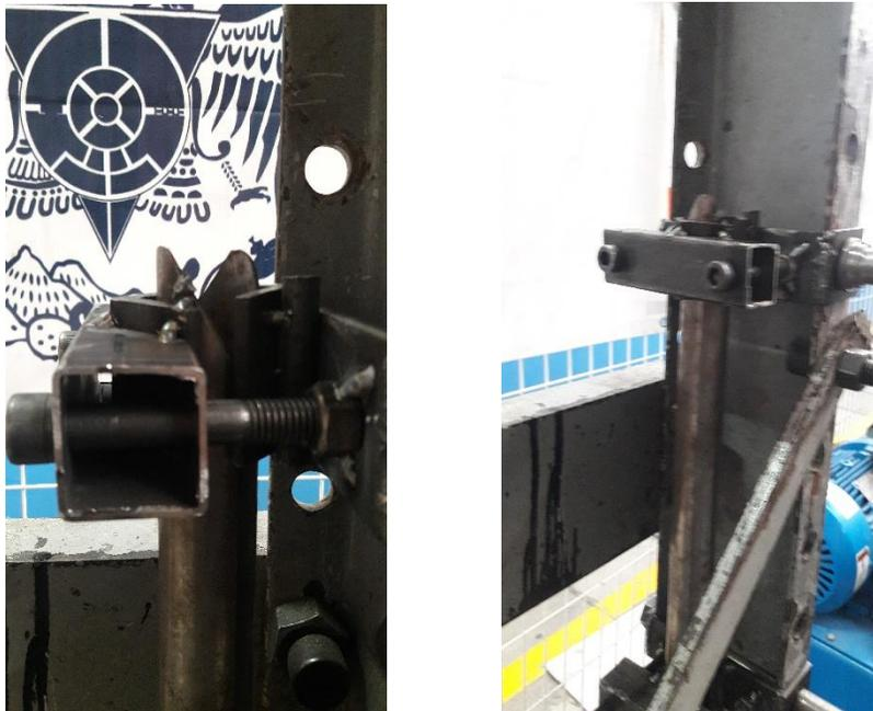
*Figura 92 Montaje y disposición de apriete en las mordazas.*
