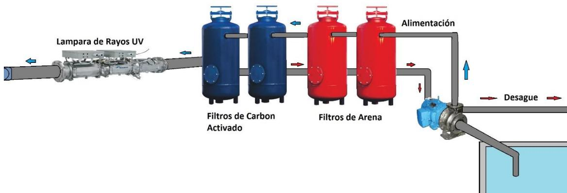
**Figura 52.** Esquema de la planta de tratamiento con los elementos seleccionados.
