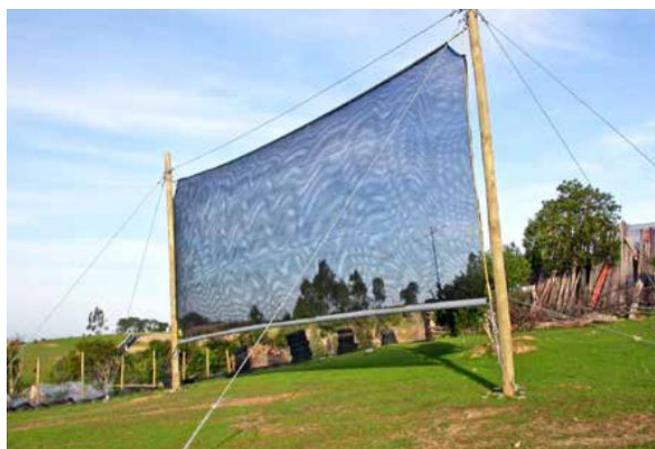
**Figura 20.** Malla de polipropileno para captación de niebla. Fuente: (PNUD y INIA, 2015)
