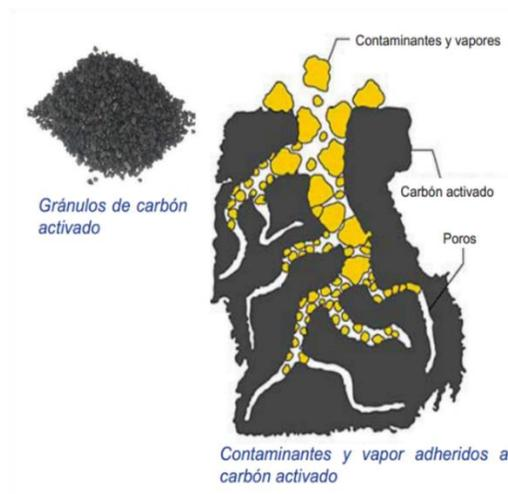
**Figura 37.** Adsorción de contaminantes en CA. Fuente: (Hidrofiltec SAC, 2015a)
