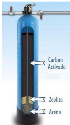
**Figura 38.** Disposición de elementos de Filtro de CA. Fuente: (Hidrofiltec SAC, 2015a)
