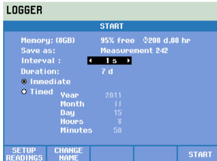
Figura 18. Pantalla de configuración logger del analizador de redes (FLUKE Corporation®, 2018).
