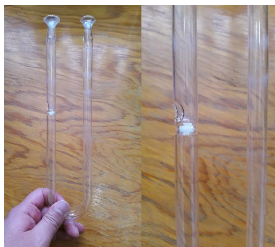
Ilustración 16. Reactor de flujo continuo con cama catalítica
