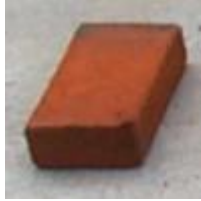
Foto 1: Tabique de arcilla recocida, Fuente: SMIE.
