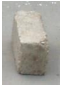
Foto 4: Piezas macizas de cemento-arena (Tabicón), Fuente: SMIE
