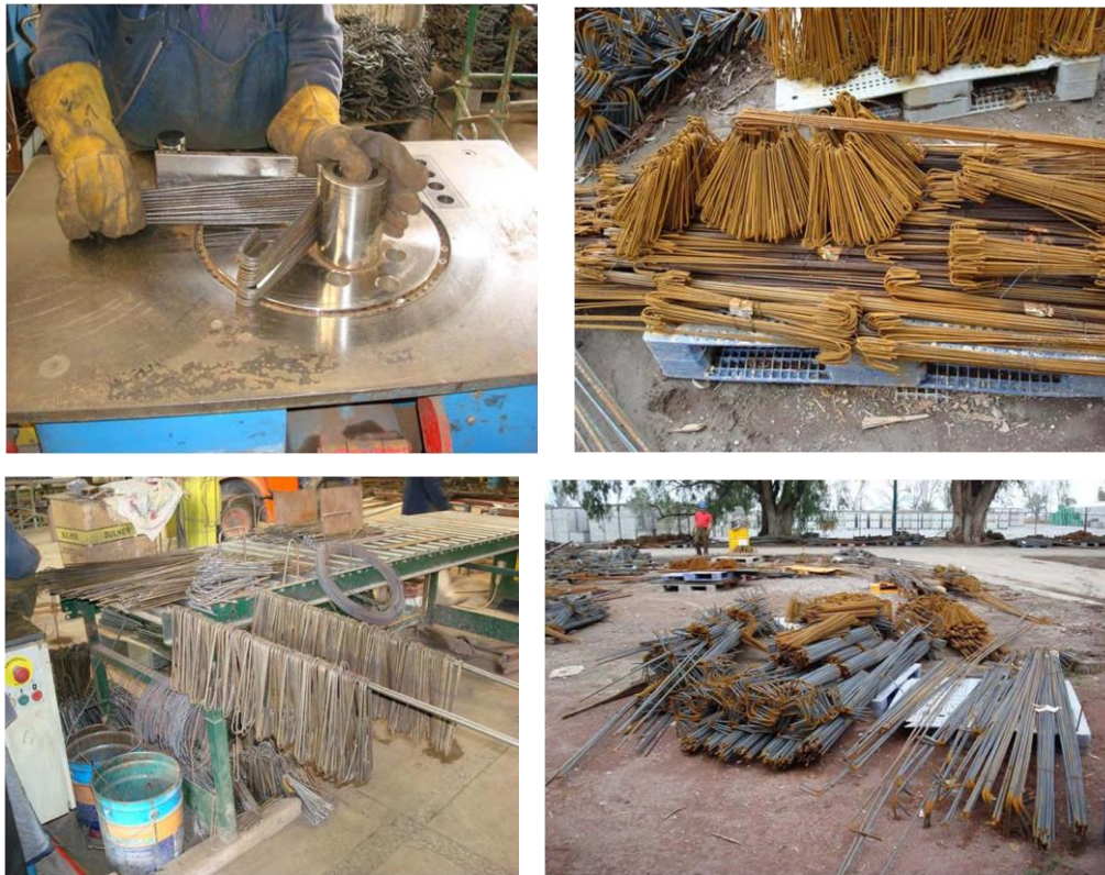
Foto 22, habilitado de acero en taller es un esquema que debe implementarse. Fuente: Propia
