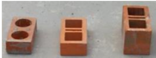
Foto 3: Tabique hueco de arcilla recocida, Fuente: SMIE
