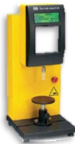
Figura 21. Texturómetro con el aditamento de cilindro perplex para la prueba de mucoadhesión.
