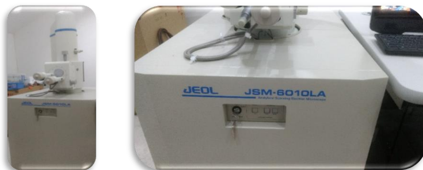
Figura 22. Microscopio electrónico de barrido Jeol JSM-6010LA.
