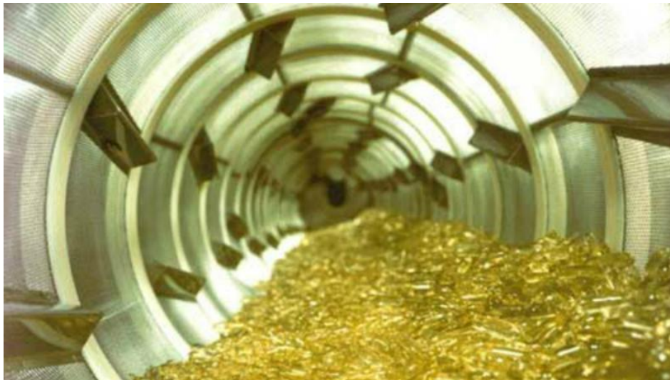
Imagen 19. Vista interna de un túnel de secado de cápsulas blandas Tomada de Pharmagel engineering. Softgel machinery and technology
