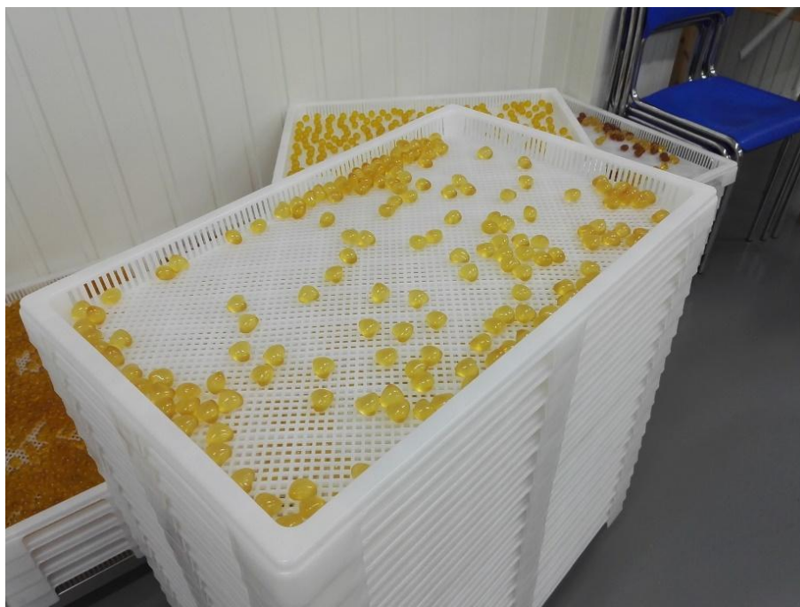
Imagen 20. Bandejas apilables para el secado final de softgels Tomada de Amazinglive, plastic manufactures 20 junio 2018.
