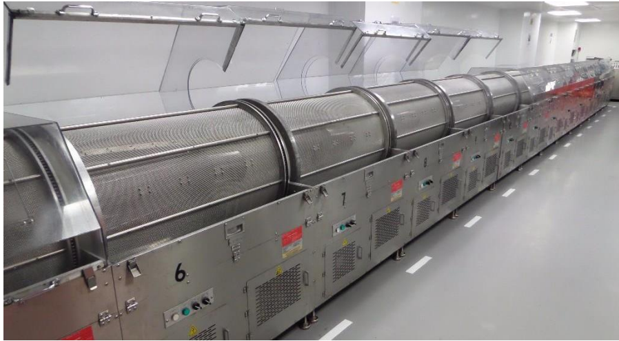
Imagen 18. Túnel de secado Tomada de (Changsung, 2012)
