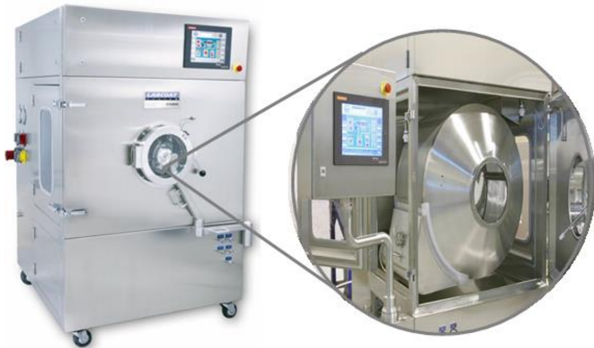
Imagen 29. Equipo de recubrimiento automatizado. Pilot™ system. Tomada de O´HARA TECHNOLOGIES, Editada por Damaris Ruiz, 2018.
