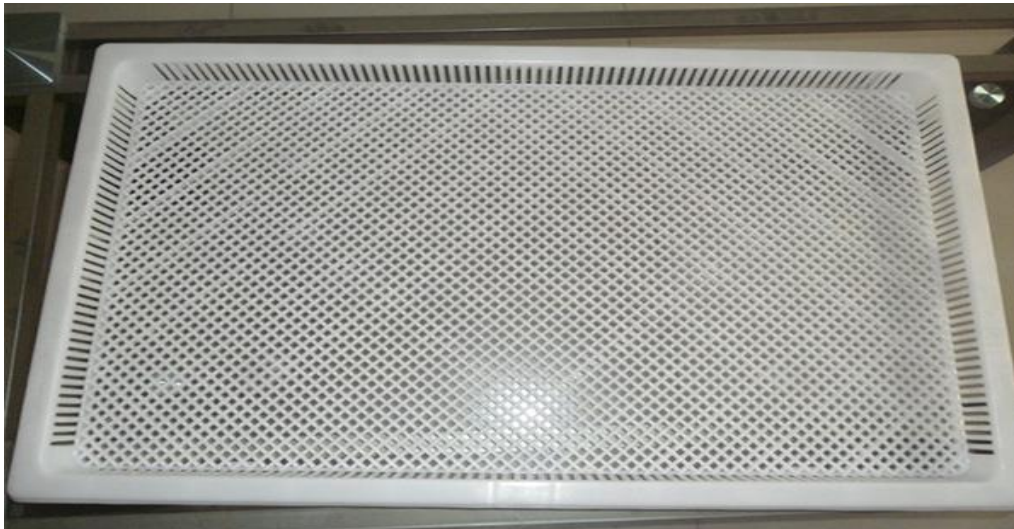
Imagen 21. Bandeja de secado secundario de softgels Tomada de JANGLI equipment.
