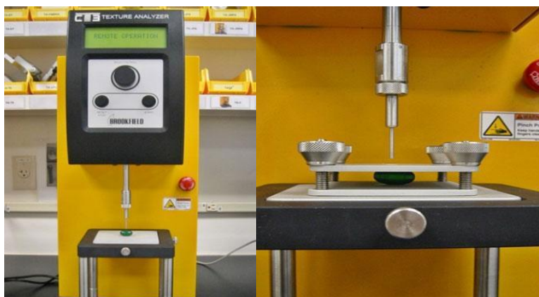
Imagen 7. Analizador de texturas CT3
