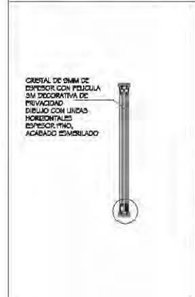
PI 1.50 PROTOTIPO DE PUERTA ABATIBLE PARA SALIDA DE EMERGENCIA EN TERRAZA
