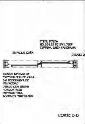
PI 1.50 PROTOTIPO DE PUERTA ABATIBLE PARA SALIDA DE EMERGENCIA EN TERRAZA
