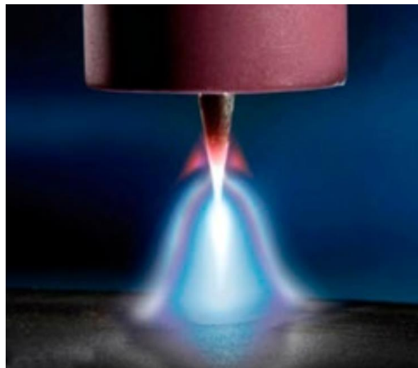
Figura 10. Imagen que muestra el plasma formado en el proceso de GTAW.
