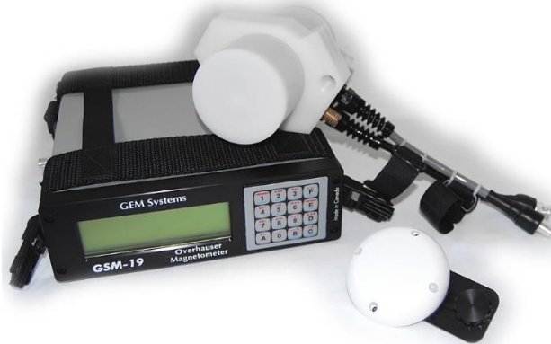
Fig. 13. Magnetómetro protónico tipo Overhauser.
