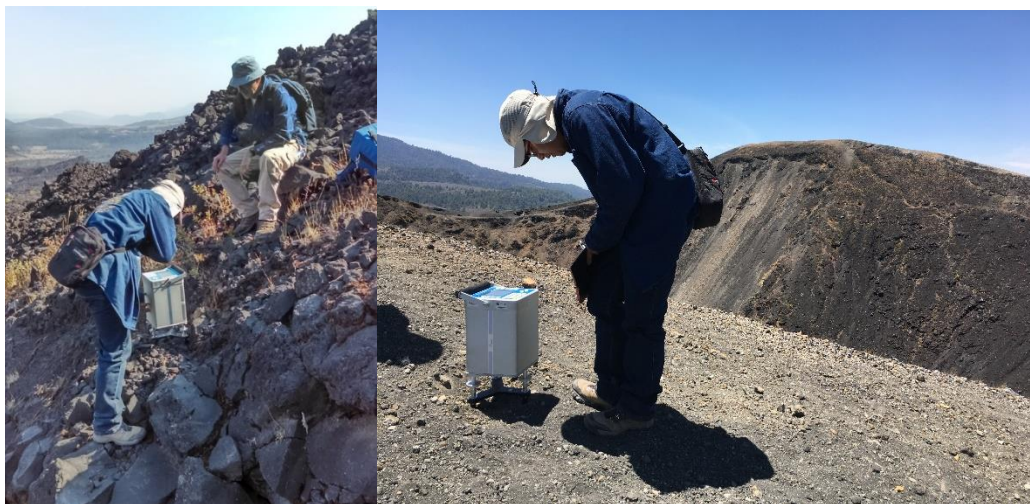
Fig. 12. Gravímetro Scintrex CG5-AUTOGRAV en operación de campo.
