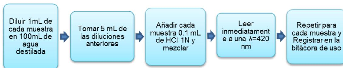
Fig. A6.1. Diagrama de bloques para la determinación de NO<sup>3-</sup>
