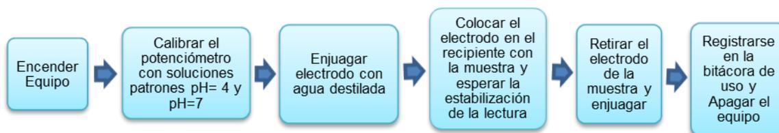
Fig. A2.1. Diagrama de bloques para la determinación de pH
