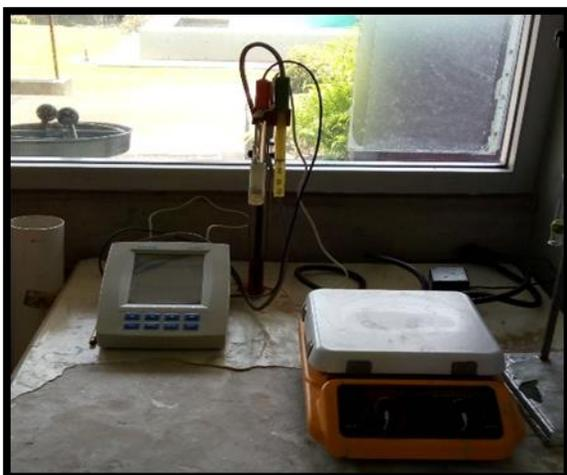
Fig. A1.5. Equipo para medición de pH, conductividad, temperatura y alcalinidad
