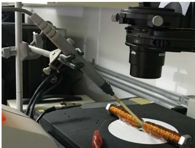
Figura 17. Fotografía del sistema con la punta del gaussímetro en el área de trabajo del sistema
