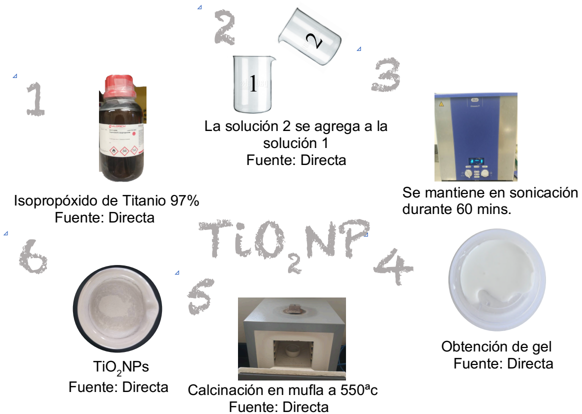
Figura 2. Representación del flujo para la síntesis de nanopartículas de dióxido de titanio técnica sol-gel.
