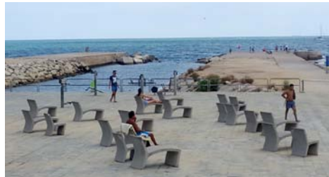
Concreto vaciado, acabado pulido
