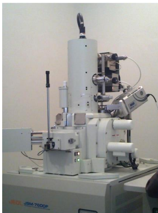
Figura 11. Fotografía del microscopio electrónico de barrido de emisión de campo del Instituto de Investigaciones en Materiales (De los Cobos, 2017).
