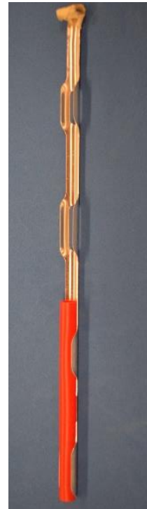
Imagen.22 Gobelete y porta Gobelete. El recipiente anaranjado es el gobelete, que está dentro de una porta gobelete.
