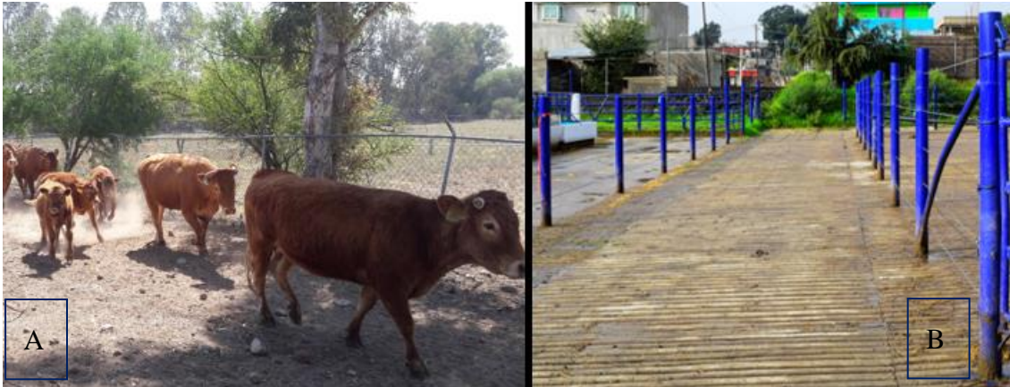
Imagen.46 Pasillos. Movilización de ganado a través de pasillos internos antiderrapantes. Panel A, pasillo de tierra. Panel B, pasillo de cemento con estriaciones.
