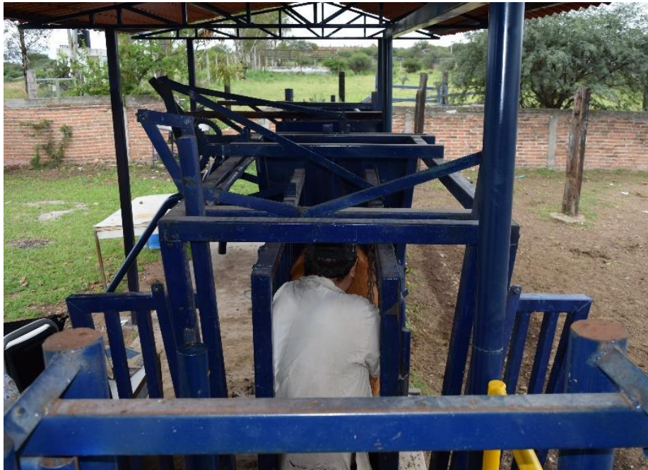
Imagen.52 Vaca en prensa. La prensa contiene a la vaca para que el usuario pueda realizar su trabajo sin riesgo aparente.
