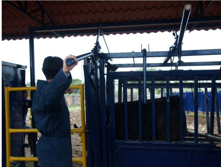
Imagen.48 Prensa de ganado. Es importante que solo un operador pueda manejarla, para evitar accidentes.
