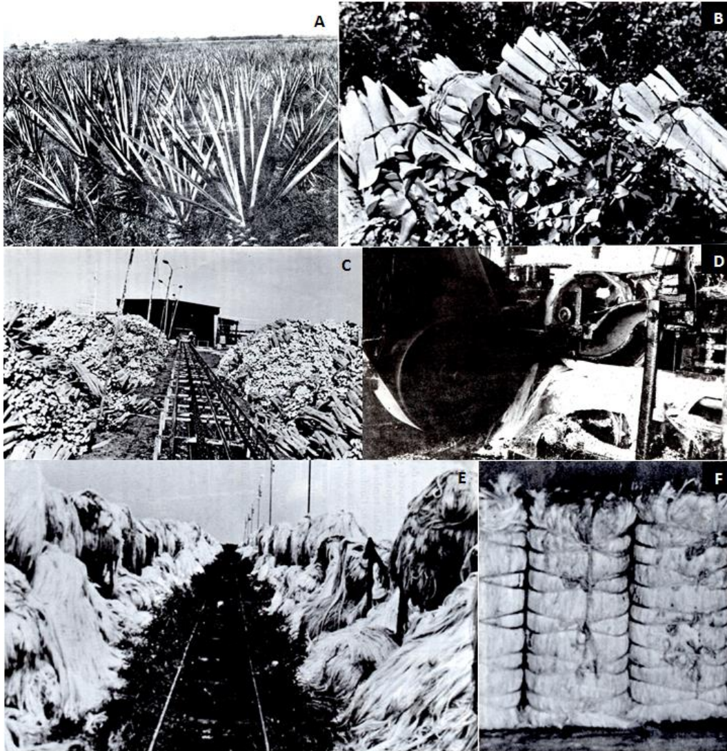
Fig. 2. A. Plantas de henequén en explotación. B. Rollos de pencas cortadas. C. Transportadora horizontal de pencas hacia el desfibrado. D. Máquina desfibadora. E. Secadero de fibras. F. Pacas de fibras listas para comercio. Imágenes tomadas y modificadas de Macossay y Castillo (1986); y Peniche Rivero (1985).
