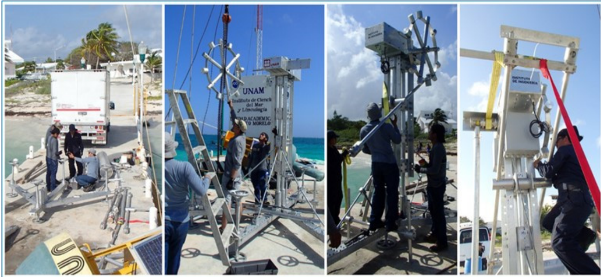
Figura 26.- Ensamble del modelo 1:10 del WEC MICO-1T in situ
