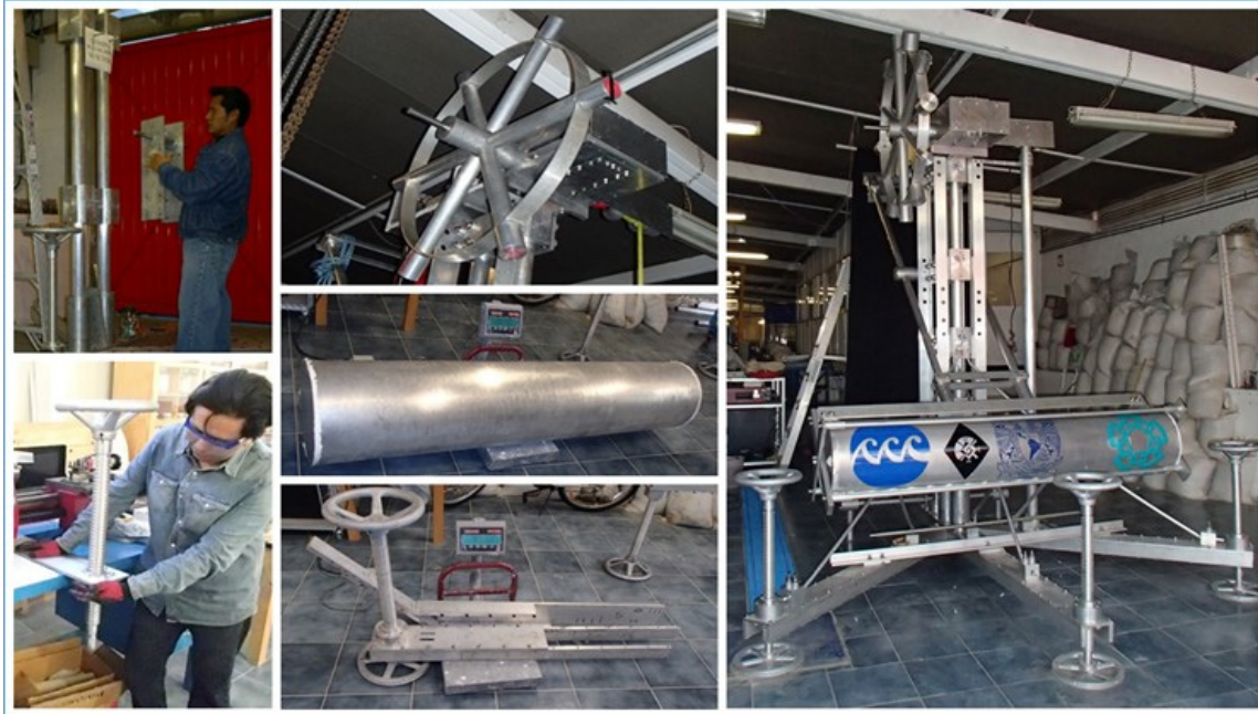
Figura 15.- Ensamble del modelo 1:10 del WEC MICO-1T, Laboratorio de Costas y Puertos de la UNAM
