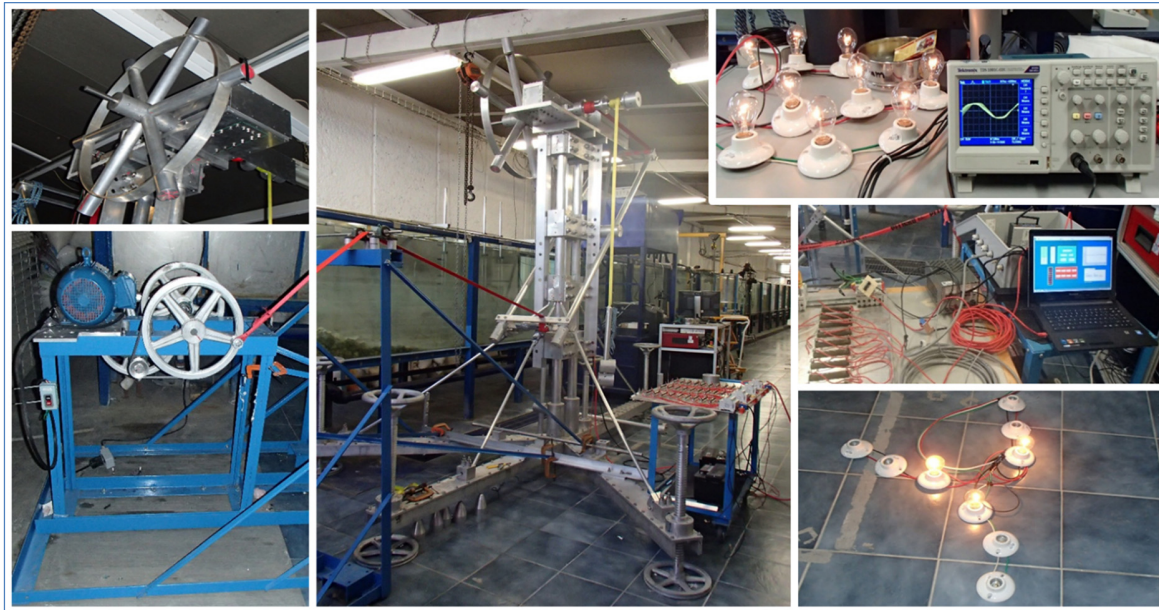
Figura 16.- Pruebas de laboratorio con el modelo 1:10 del WEC MICO-1T
