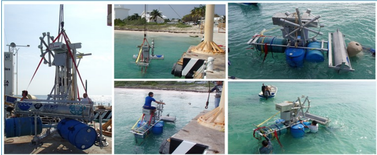
Figura 28.- Pruebas de flotabilidad del WEC MICO-1T en campo
