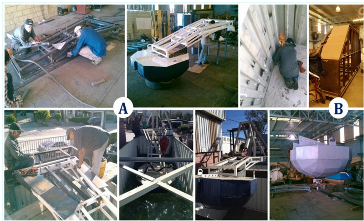
Figura 34.- Sistema de captación de energía del WEC DINA-EF
