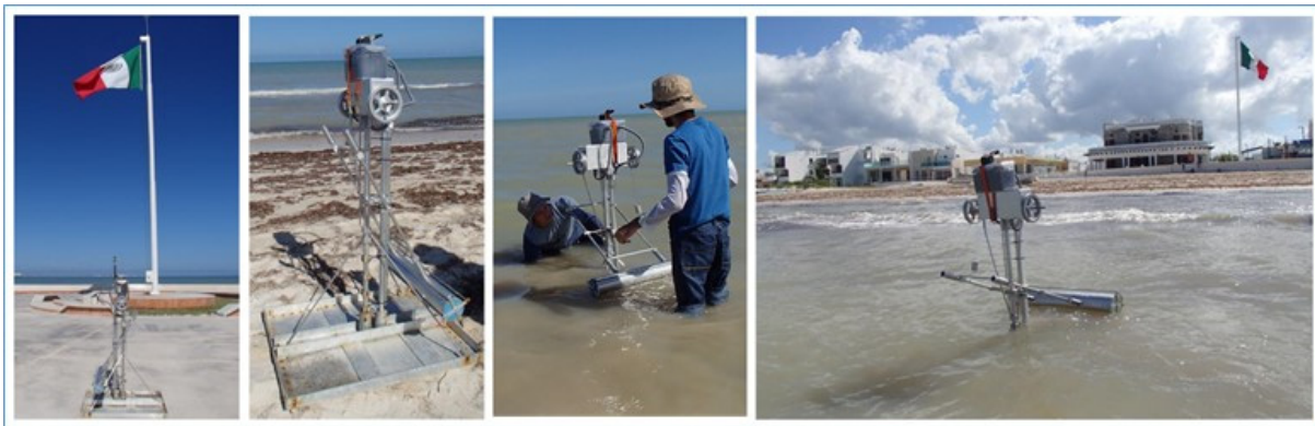
Figura 23.- Pruebas en campo con el modelo 1:20 del WEC MICO-1T
