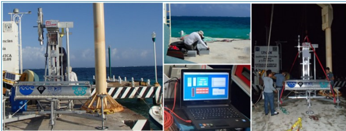
Figura 27.- Pruebas de comunicación, descarga de datos e izaje del prototipo
