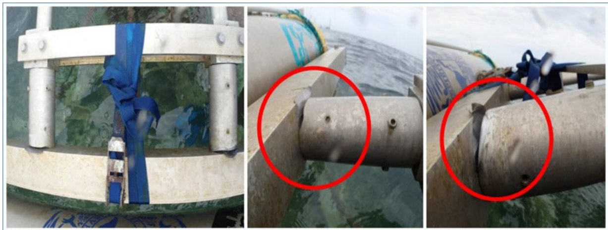
Figura 50.- Pieza de unión boya-brazo del WEC MICO-1T desgastada por fricción
