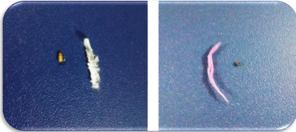
Figura 17. Prueba de combustión para algodón y Nylon (izq. a der.)
