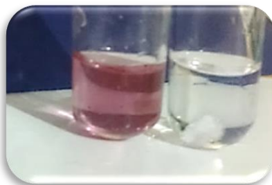
Figura 15. Nylon y algodón (izq. a der.) en disolución de HCl 35%
