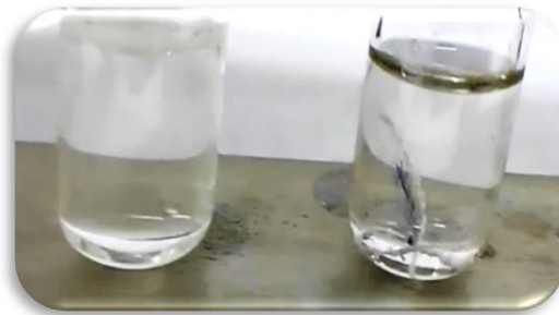
Figura 14. Fibras de lana y lino (de izq. a der.) en una disolución de NaClO al 10%
