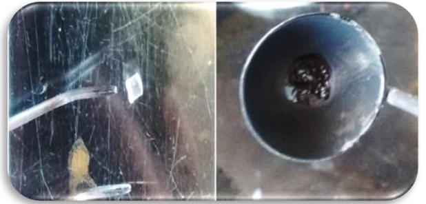
Figura 21. Comparación de polímero de poliestireno de alto impacto (HIPS) antes de la combustión y el residuo de este después de la combustión.
