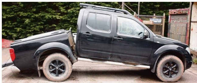
Imagen 13 vehículo con falla a flexión [14]
