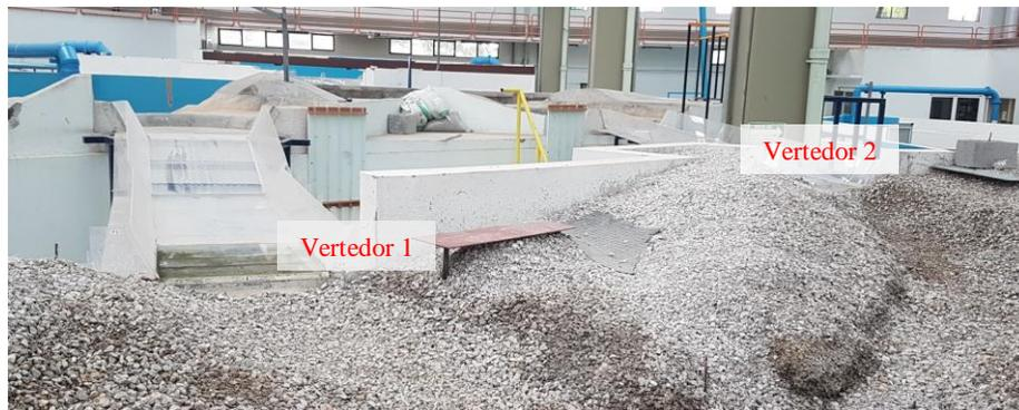
Figura 4.6: Conformación de la topografía en el modelo.
