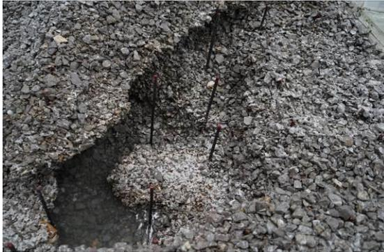
Formación de cavidades en el V1, utilizando material cohesivo,  $Q_m=0.065 \text{ m}^3/\text{s}$ . Primera prueba.
