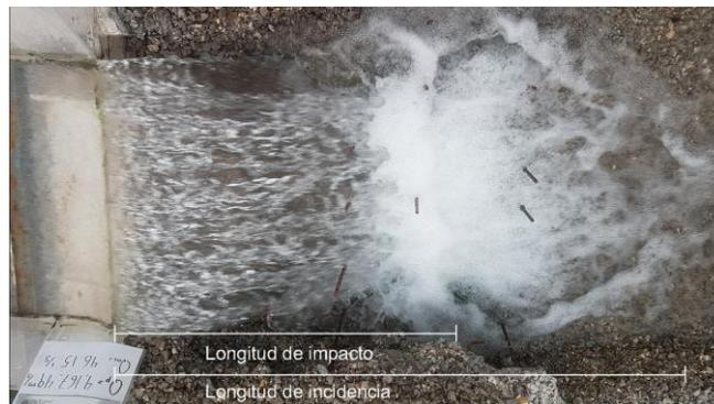
Figura 7.1: Forma de medición de la longitud de impacto y la longitud de incidencia.
