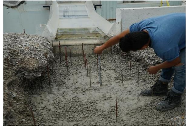
b) Medición del espesor de la capa
