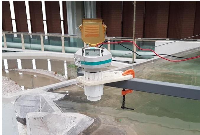
Figura 5.1: Sensor de nivel Siemens®.
