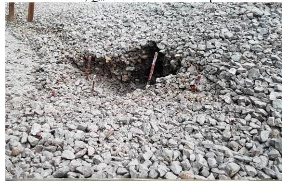
Formación de cavidades en el V1, utilizando material cohesivo,  $Q_m=0.079 \text{ m}^3/\text{s}$ . Segunda prueba.
