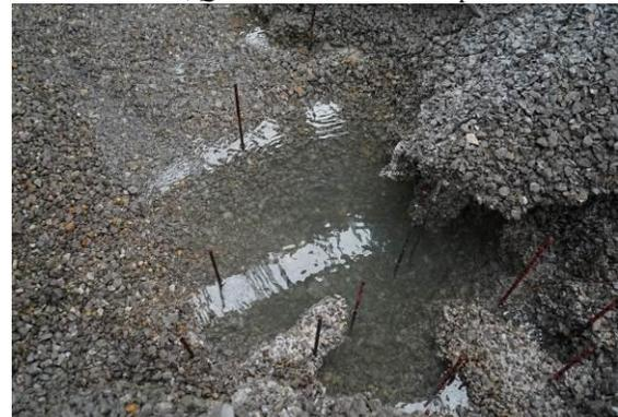
Formación de cavidades en el V1, utilizando material cohesivo,  $Q_m=0.079 \text{ m}^3/\text{s}$ . Primera prueba.
