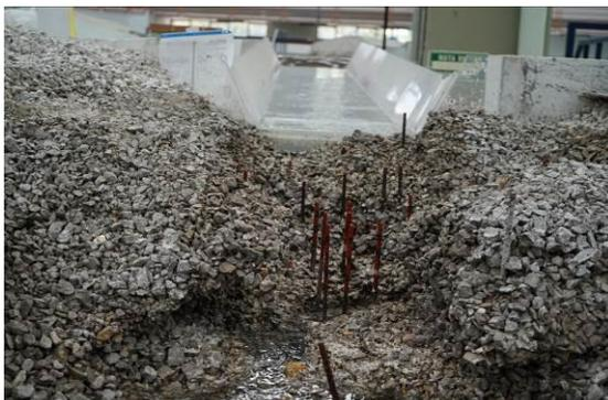
Socavación transversal del V2, utilizando material cohesivo,  $Q_m=0.064 \text{ m}^3/\text{s}$ . Primera prueba.
