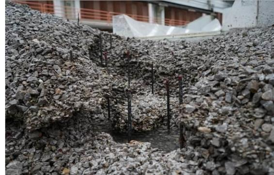
Formación de cavidades en el V1, utilizando material cohesivo,  $Q_m=0.065 \text{ m}^3/\text{s}$ . Primera prueba.
