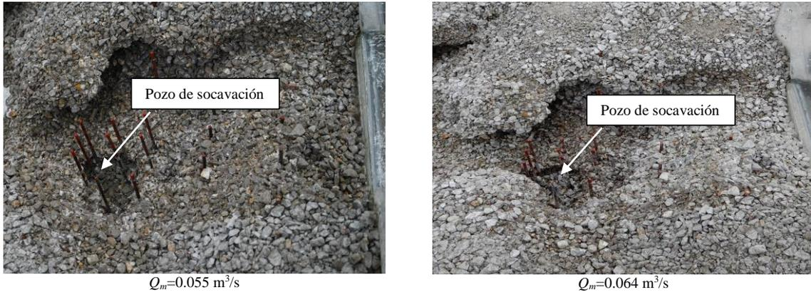
Figura 8.9 : Socavación del V2 utilizando material cohesivo durante la primera prueba.
