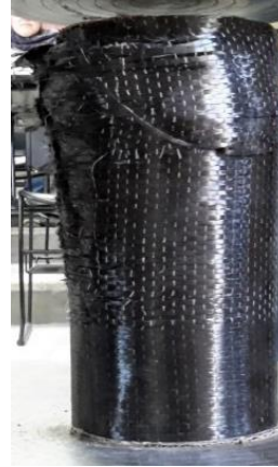
b) Falla a compresión del cilindro
