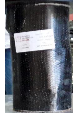
c) Falla a compresión del cilindro
