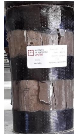
b) Falla a compresión del cilindro
