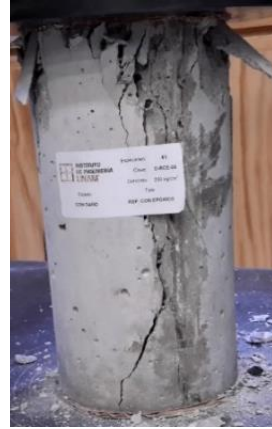
b) Falla a compresión del cilindro
