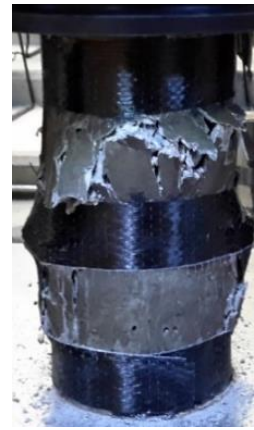
b) Falla a compresión del cilindro
