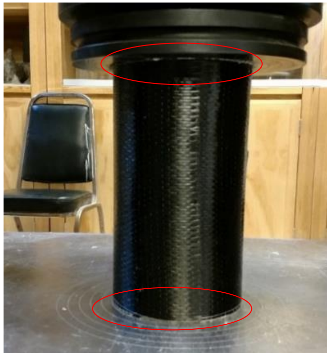
Figura 3.16. Uso de protecciones para evitar daños en la máquina universal y como sistema de cabeceo
