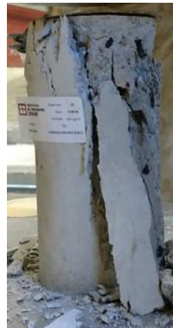
b) Falla a compresión del cilindro
