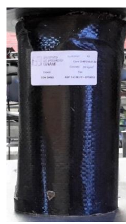
c) Falla a compresión del cilindro
