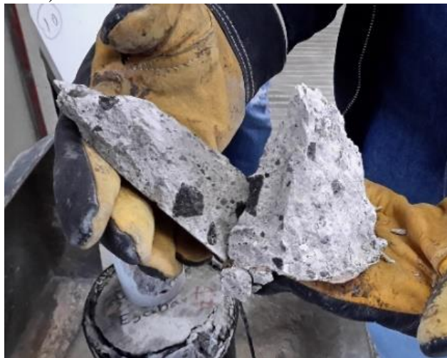
a) Interior cilindro de concreto llevado a la falla
