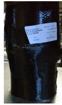
c) Falla a compresión del cilindro
