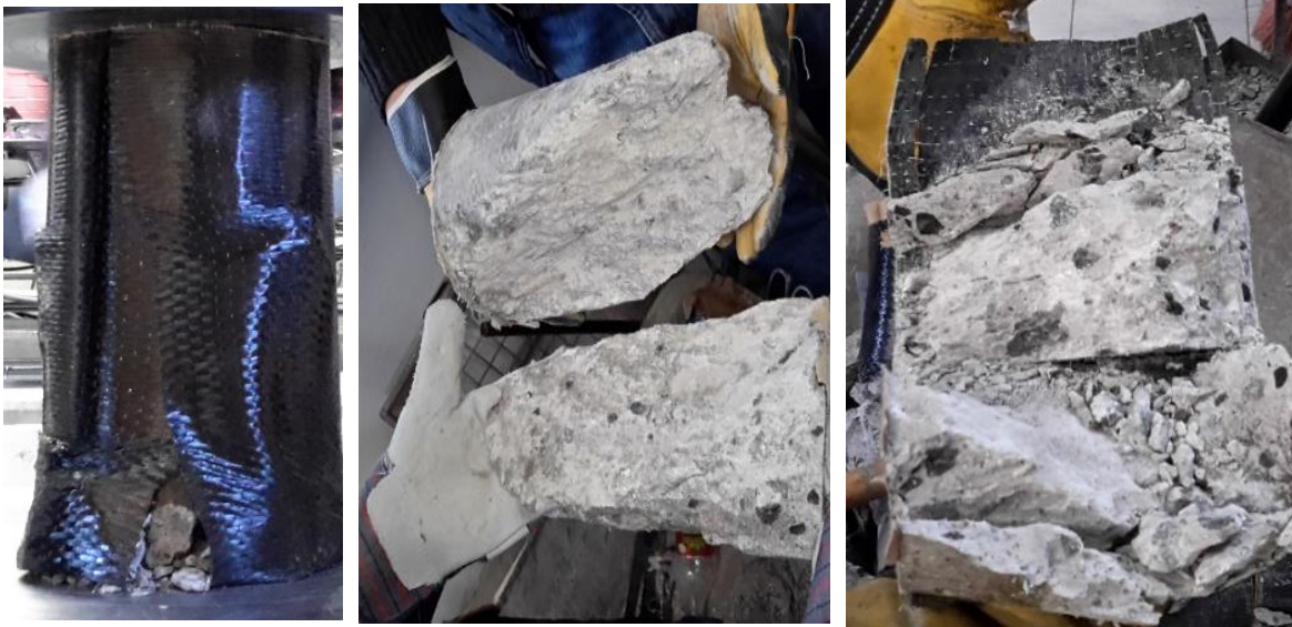
Figura 3.14. Falla de cilindros sometidos a carga axial
