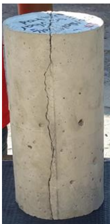
a) Grieta simulada (cilindro dividido en dos partes)
