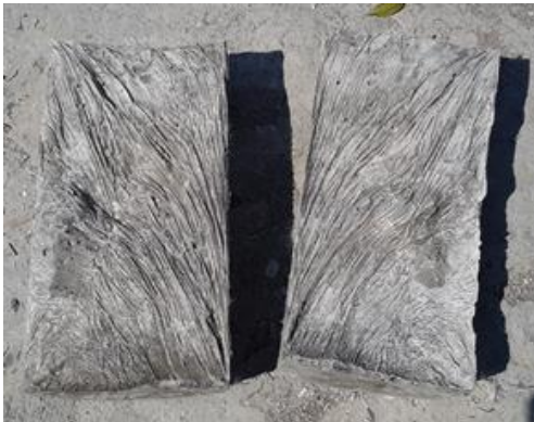
a) Grieta simulada (cilindro dividido en dos partes)
