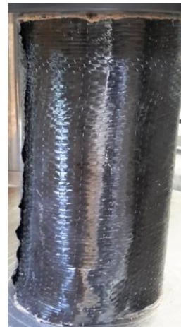
b) Falla a compresión del cilindro
