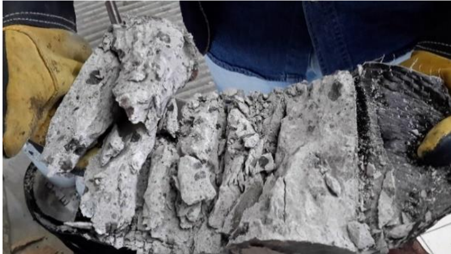
a) Interior cilindro de concreto llevado a la falla
